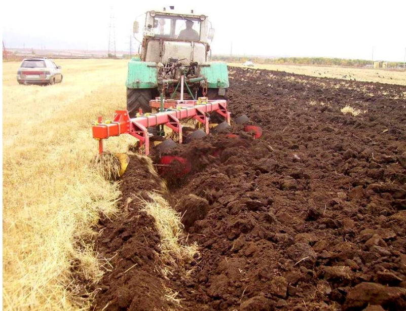
Рис. 1. Работа комбинированного плуга в агрегате с трактором Т-150К
