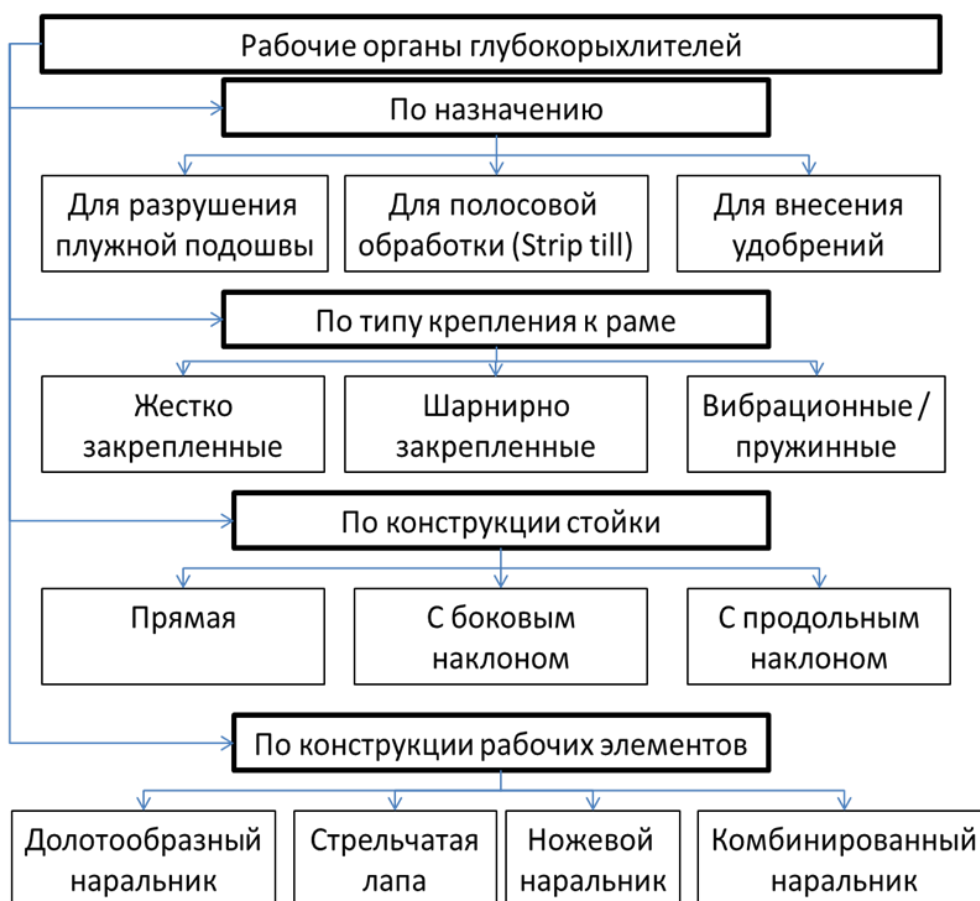
Рис. Классификация рабочих органов глубокорыхлителей
