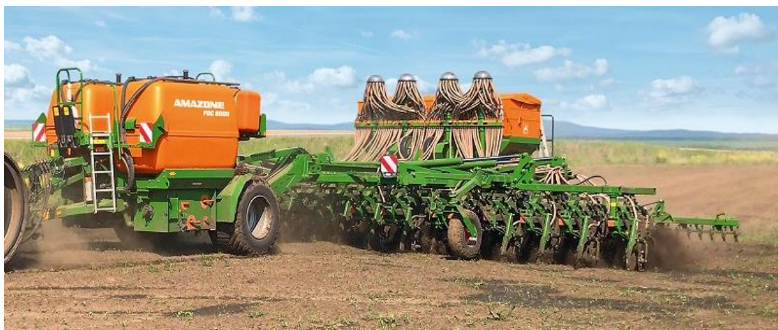
Рис. 4. Сеялка Primer DMC с инновационным агрегатом FDC-6000 для внесения КАС-32
