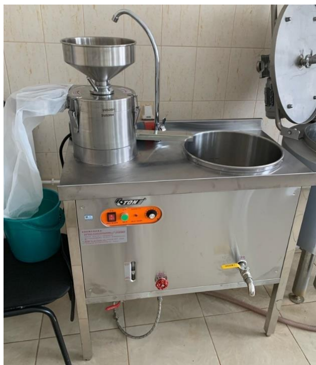
Рис. 1. Станок для производства соевого молока ЕТ-10А (электрический)
